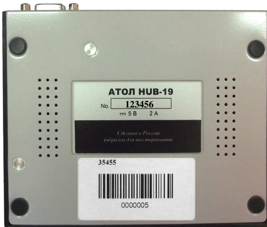
Рисунок 9. Расположение маркировки на нижней части корпуса УТМ АТОЛ HUB-19
